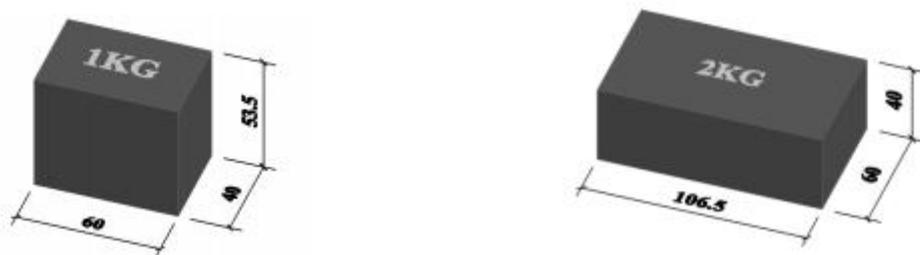
图4 砝码尺寸示意图（单位：mm）
